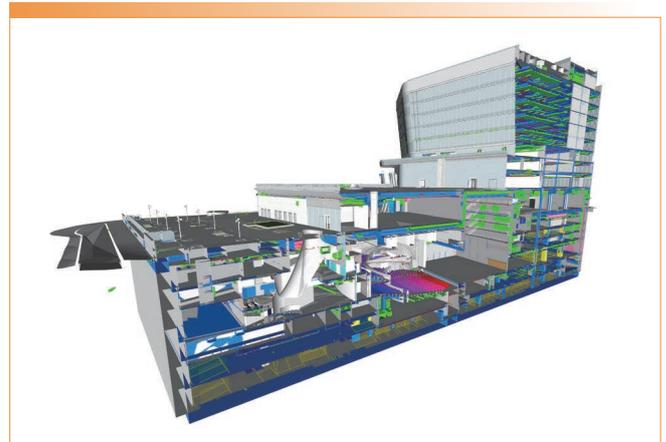
項目參與方以BIM模型做溝通媒介，實現設計、施工、竣工全流程數位化管理
