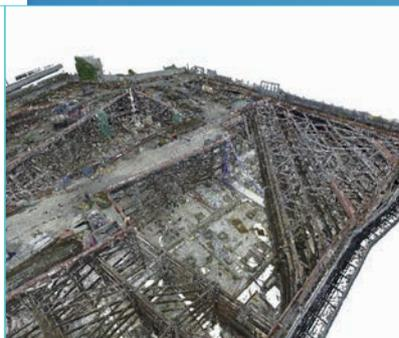
在施工完成後，以航拍攝影測量現場環境及更新竣工圖，對比與設計圖紙的貼合度。
